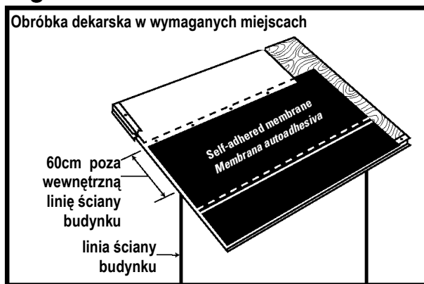
Rys. 1 Specjalna obróbka dekarcka okapów
